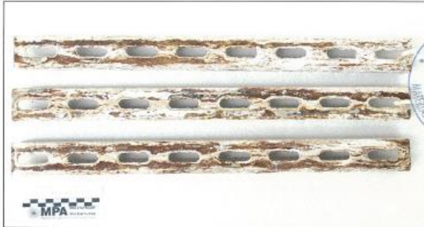
Afbeelding 1: proeven A1 t/m A3 na 1.440 uur zoutspoei test
