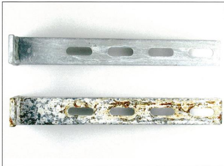
Afbeelding 5: Railconsole 41/41–300 na 1.440 uur zoutsproei test; boven EOT 400 onder thermisch verzinkt
